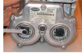
**Note : si l'erreur est supérieure à 0.05%, supprimer l'erreur en réglant les deux vis d'égale façon.**
