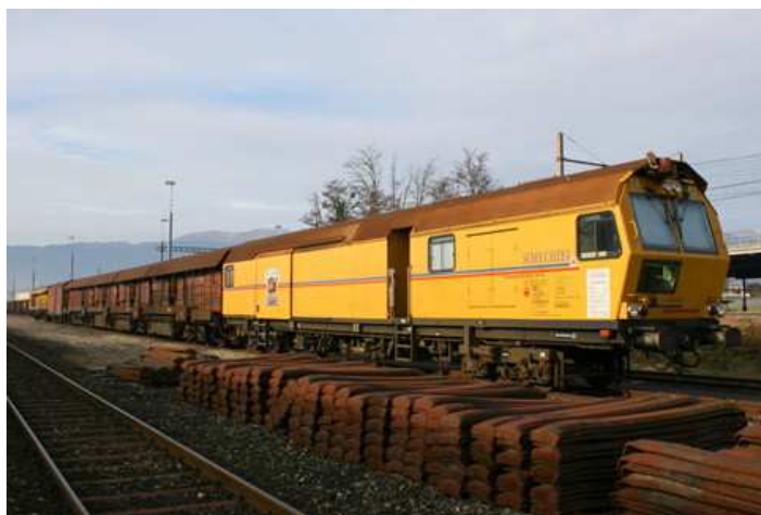
Train meuleur de rails (Scheuchzer S.A.)
