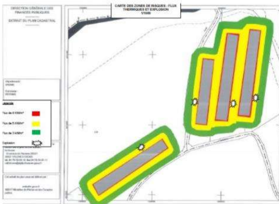
Figure 2: carte des zones de risques: flux thermiques et explosions (source étude de dangers)
