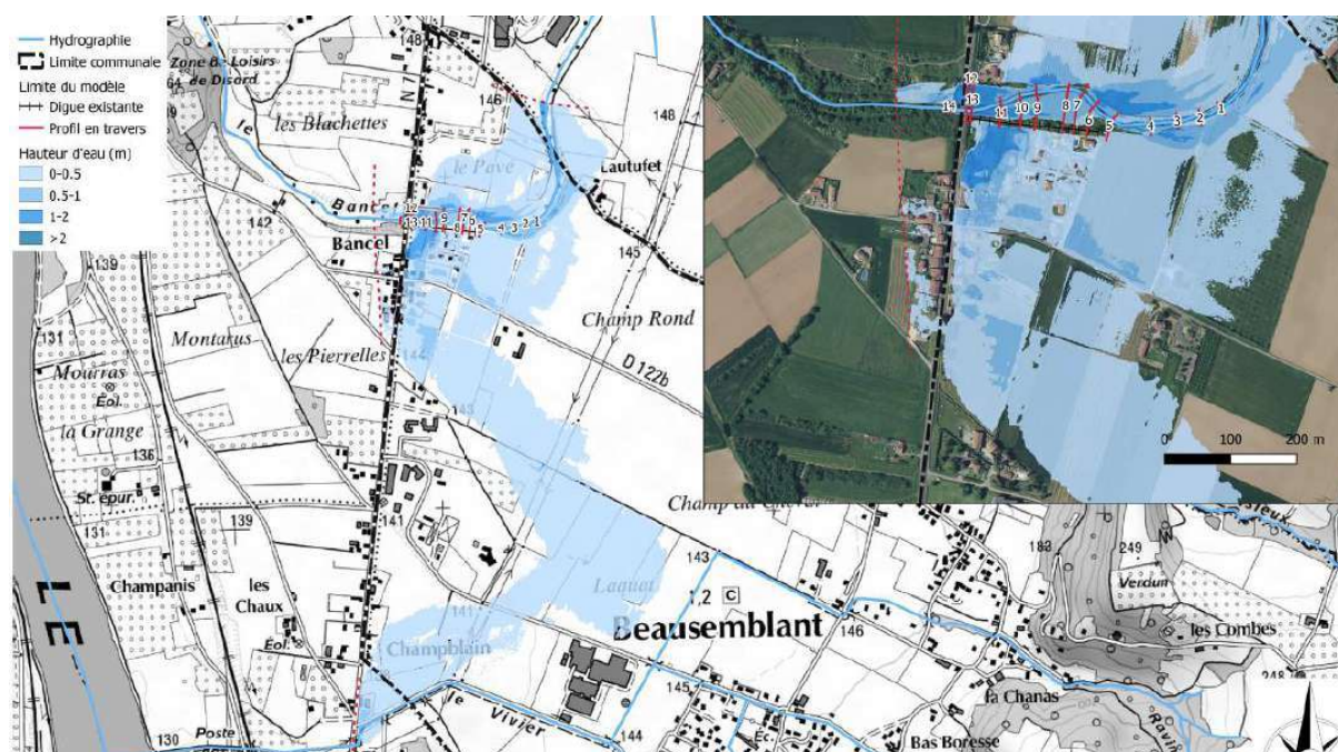
Figure 18 : Carte des hauteurs d'eau pour la crue centennale à l'état initial sur la zone d'étude
