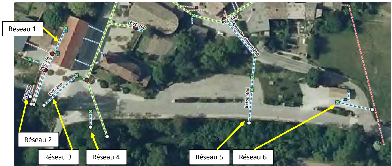
LOCALISATION DES RESEAUX D'EAUX PLUVIAUX
