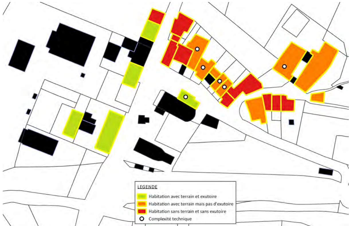
RECENSEMENT DES POSSIBILITES ANC DES HABITATIONS DU VILLAGE Source : Fond cadastral étalab donnée libre – Mise en forme BET A. LÉGAUT
