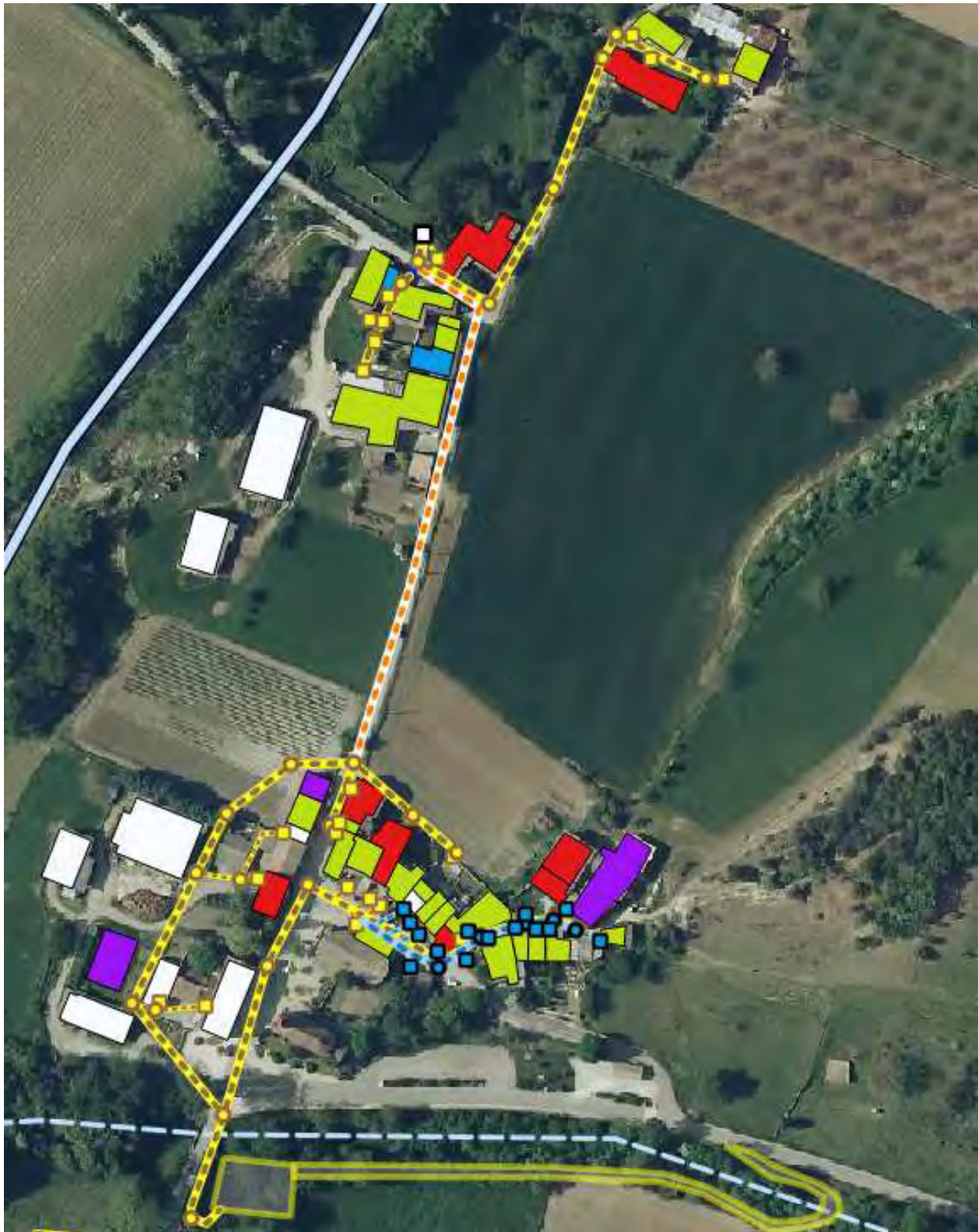
SCENARIO 4 : Réseau EU séparatif et refoulement à créer, station d'épuration et chemin d'accès Source : BD ORTHO IGN – Mise à disposition conventionnée – Mise en forme BET A. LÉGAUT
