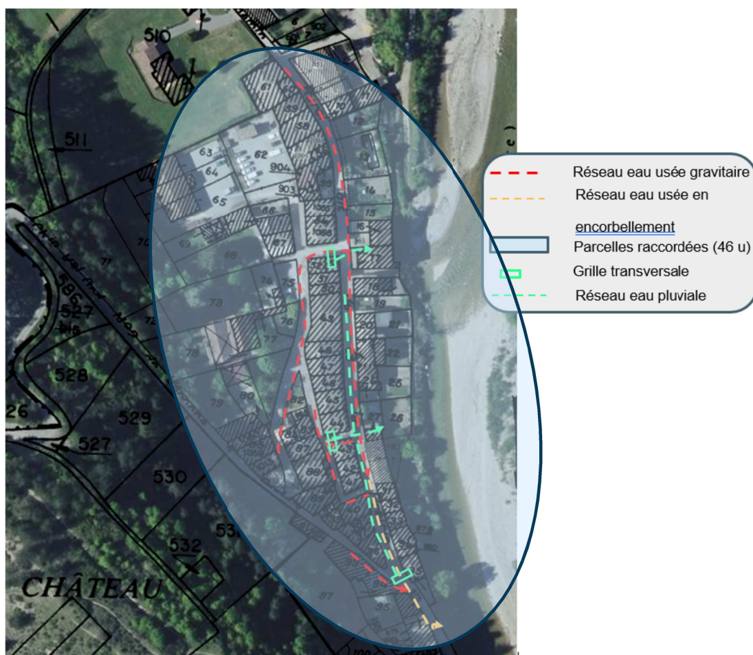
Figure 11 : Tracé solution 4 : secteur Rive Droite Nord
