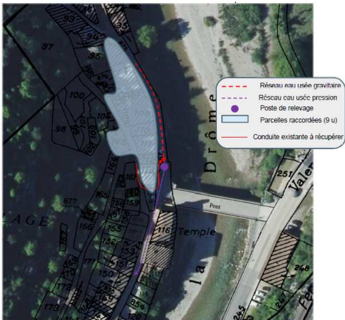
Figure 12 : Tracé solution 2 - Secteur Rive Droite Centre
