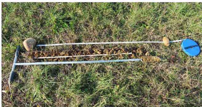
Matériel nécessaire au sondage : tarière pédologique, mètre, gouttière Photos prises dans la zone d'étude – ECOTER 2019
