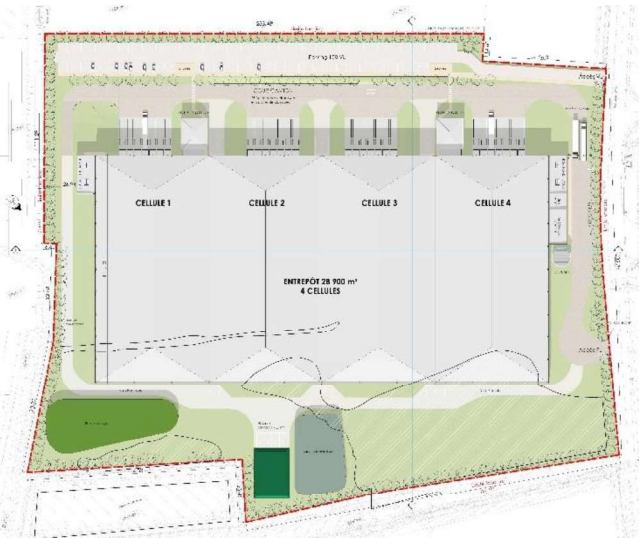
Version du 31/08/2020 : 75% enveloppe foncière artificialisée - Première phase d'évitement et de conception du projet, le parking VL est positionné à l'extrémité nord de la limite foncière de manière à déplacer vers le nord l'emprise d'installation de l'entrepôt logistique. Cette conception du plan masse intègre une meilleure prise en compte des enjeux écologiques situés dans la partie sud-est. - Source : ARGAN
