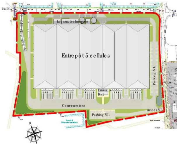
Version du 05/03/2019 : 100% enveloppe foncière artificialisée - Première conception du plan masse visant à l'optimisation de l'espace pour l'installation d'une plateforme logistique entrainant une prise en compte limitée des enjeux écologiques - Source : ARGAN
