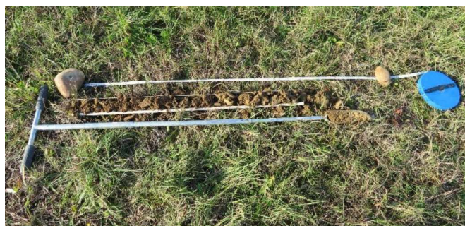
Matériel nécessaire au sondage : tarière pédologique, mètre, gouttière Photos prises dans la zone d'étude – ECOTER 2019
