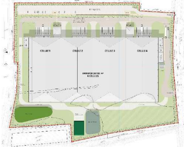
Version du 31/08/2020 : 75% enveloppe foncière artificialisée - Première phase d'évitement et de conception du projet, le parking VL est positionné à l'extrémité nord de la limite foncière de manière à déplacer vers le nord l'emprise d'installation de l'entrepôt logistique. Cette conception du plan masse intègre une meilleure prise en compte des enjeux écologiques situés dans la partie sud-est. - Source : ARGAN
