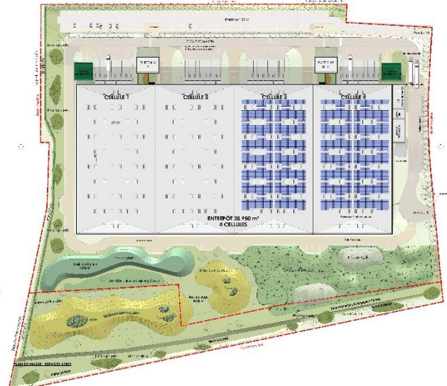
Version du 27/09/2021 : 75% enveloppe foncière artificialisée - Préfiguration des mesures compensatoires afin de valoriser et restauration des humides d'intérêt dans la partie sud de l'emprise projet. De plus, une extension de la frange sud est réalisée au bénéfice d'une gestion écologique différenciée et de restauration des zones humides en densifiant encore l'activité vers le nord. - Source : ARGAN
