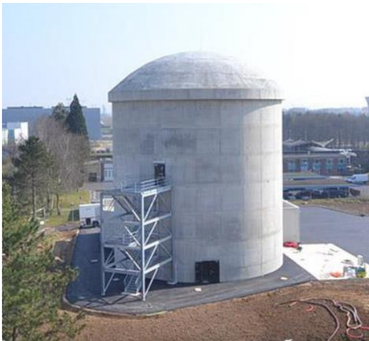
Banc d'essai VeRCoRs à échelle 1/3
