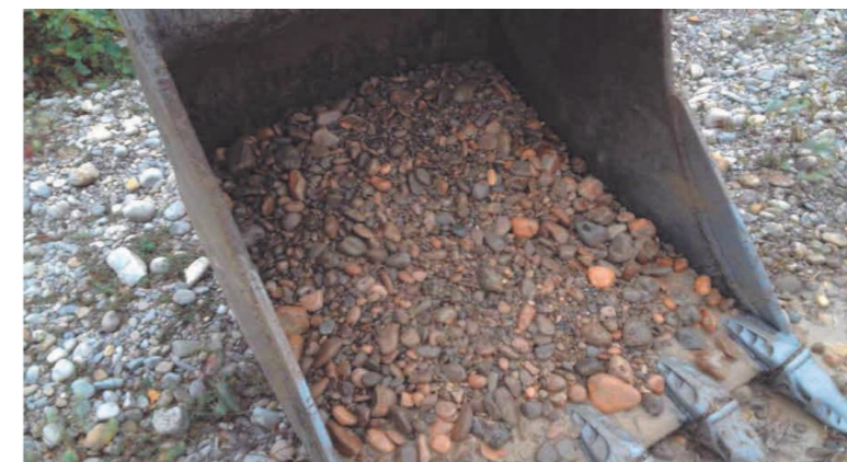
Figure 79 : Exemple de sédiments graveleux dragués dans le piège à sédiments et utilisés pour le comblement.
