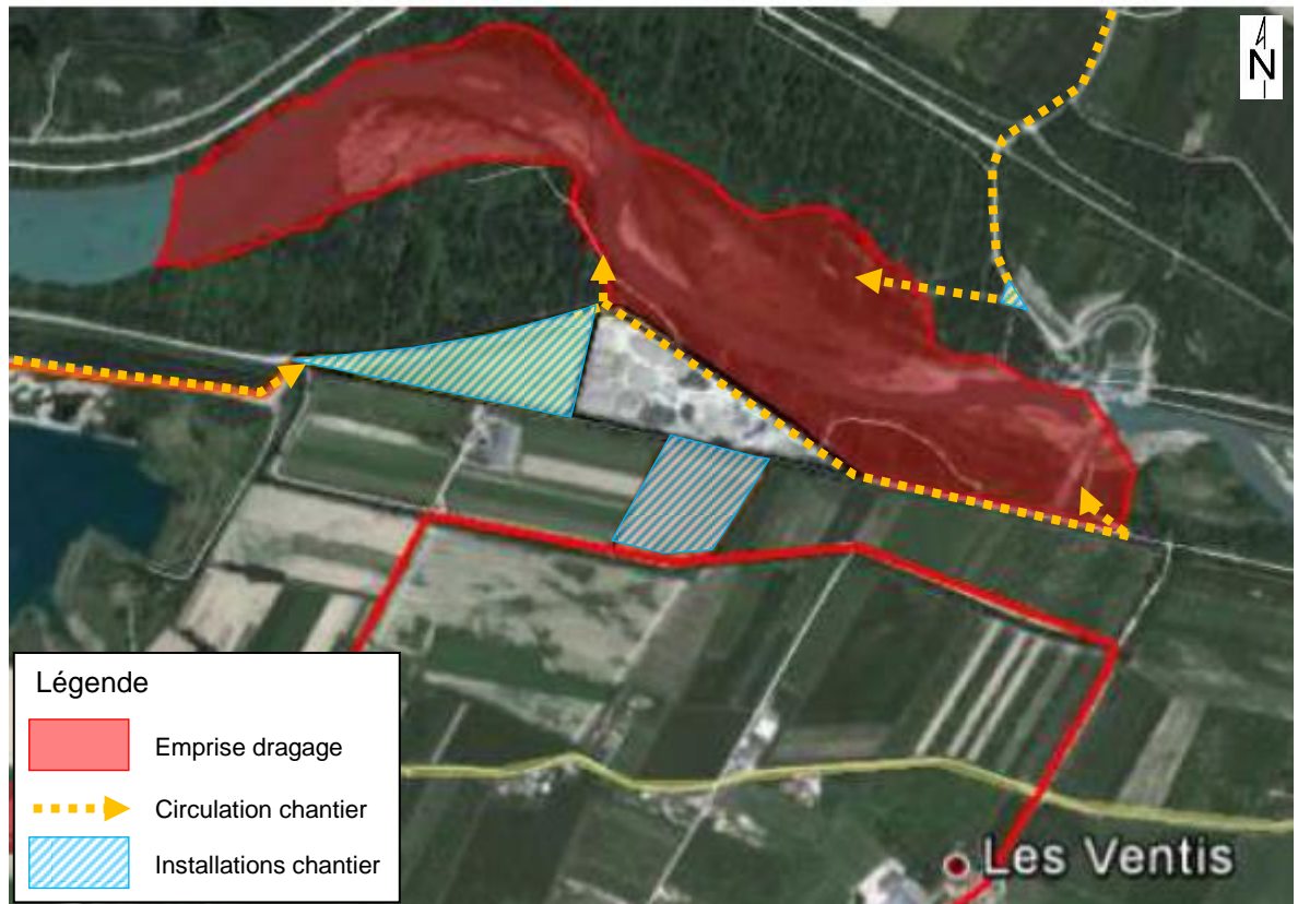
Figure 3. Détail des voies de circulations et des sites de stationnements des engins
