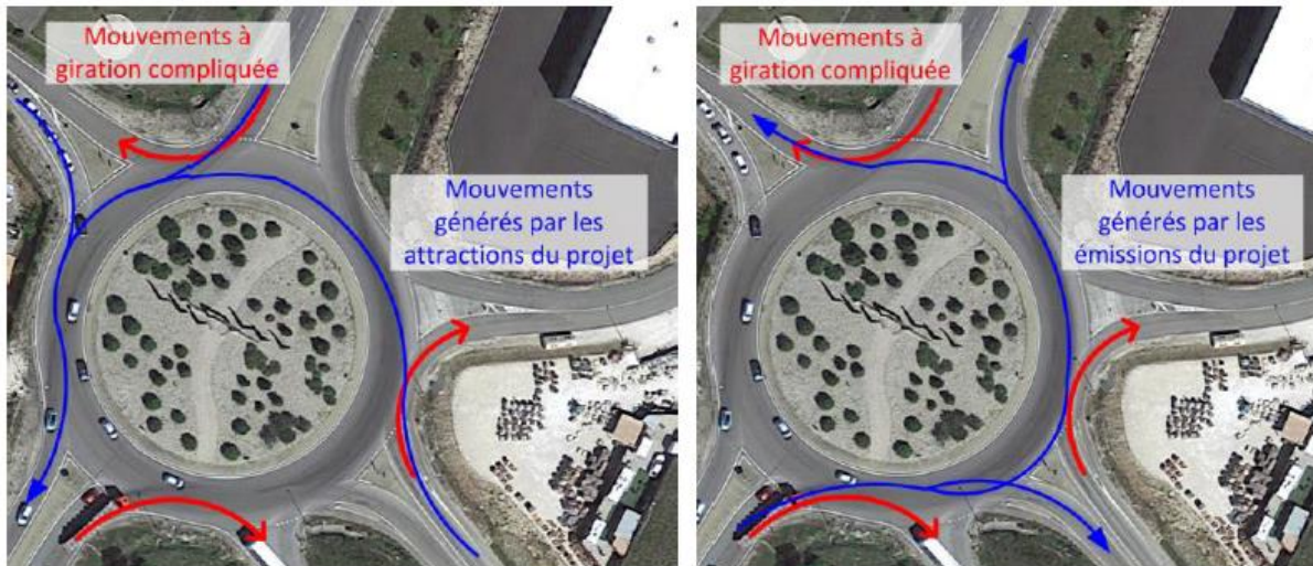
Mouvements tournants générés par le projet au niveau du giratoire RN7 – D133
