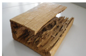
Action des termites sur le bois – source/FCBA
