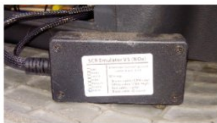
Photos de dispositifs de neutralisation du système de dépollution (dit « émulateurs AdBlue»)
