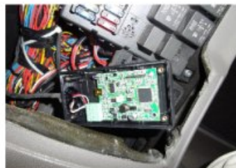
Photos de dispositifs de neutralisation du système de dépollution (dit « émulateurs AdBlue»)
